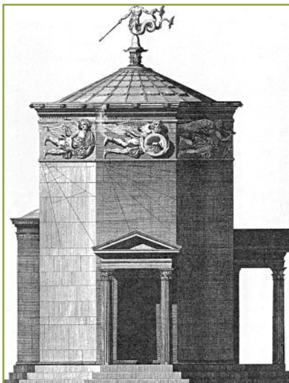
Εικ. 17. Το Ωρολόγιον του Κυρρήστου στη ρωμαϊκή αγορά των Αθηνών συνδυάζει ένα υδραυλικό ρολοί στο εσωτερικό, με ένα ηλιακό ρολοί στο εξωτερικό και ανεμοδείκτη στην οροφή
